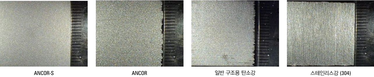
황산 침적 시험 후 시험편의 부식 형상(70°C, 20%염산, 6시간)
